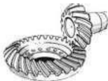
Рис. 20 Конические колёса с круговым зубом
