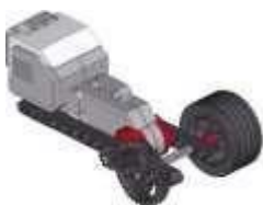
Рис.25 Комбинация, уменьшающая скорость
