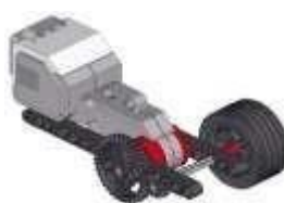
Рис.26 Комбинация, увеличивающая скорость
